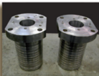
Packungen vorher und nach der Wiederinstandsetzung
