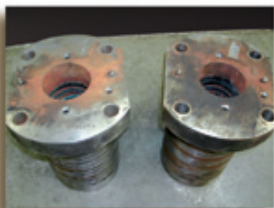
Packungen vorher und nach der Wiederinstandsetzung
